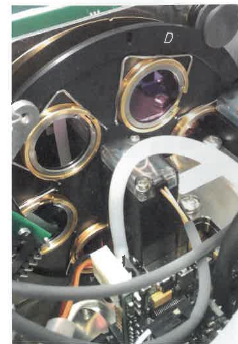
2. attēls. Optisko filtru rats ar priekšplānā redzamo mikrofonu virs testēšanas šūnas.
