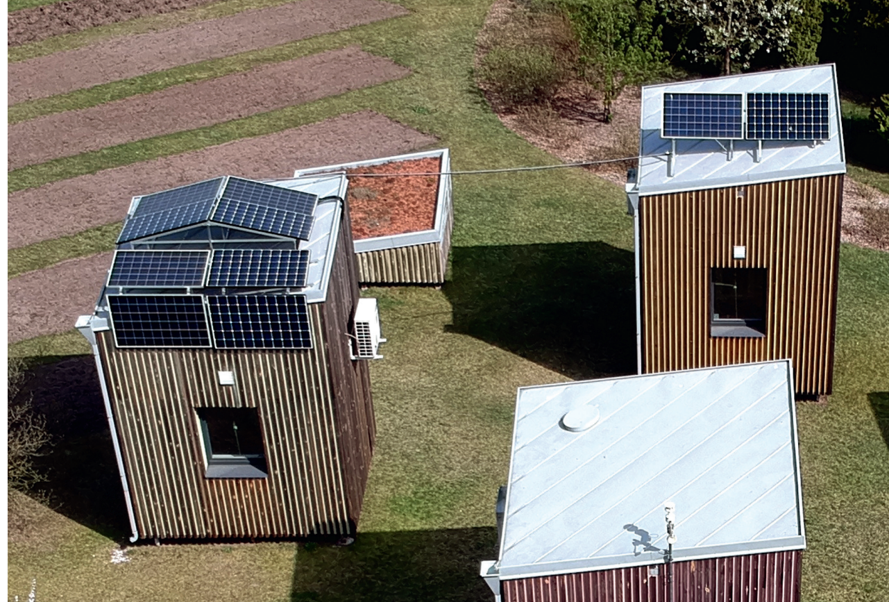
7. attēls. Dažādas orientācijas eksperimentālie saules paneļi.
